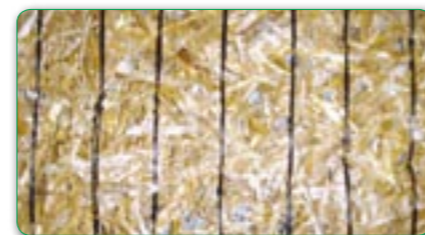
BonTerra ® S Strohmatte Beidseitige Polypropylen-Vernetzung. Schnelle Verrottung des Strohs. Für mäßig steile Böschungen. Für den kurzfristigen Erosionsschutz.
