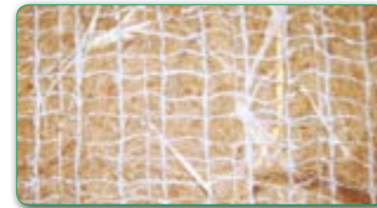
BonTerra ® SK Stroh/Kokosmatte Beidseitige Jute-Vernetzung. Für steile Böschungen mit mittleren Wasserablaufgeschwindigkeiten. Der Strohannteil verrottet schneller als die Kokosfaser. Für den mittelfristigen Erosionsschutz.
