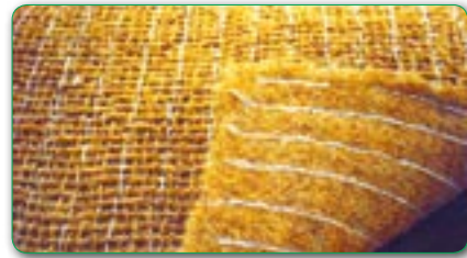
BonTerra ® KCN Auf der Oberseite mit einem Kokosgewebe zur Verstärkung versteppt. Für Flächen mit starker Erosionsgefahr und langwieriger Vegetationsetablierung.
