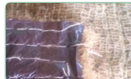
BonTerra ® KMBF Kokosfasermatte, versteppt mit kompostierbarer, geschlitzter PE-Folie auf der Rückseite. Zur Vermeidung von unerwünschtem Bewuchs durch Abdunklung des Bodens bei gleichzeitigem Durchlass von Feuchtigkeit.
