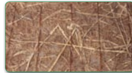
BonTerra ® SK Stroh/Kokosmatte Beidseitige Polypropylen-Vernetzung. Für steile Böschungen mit mittleren Wasserablaufgeschwindigkeiten. Der Strohannteil verrottet schneller als die Kokosfaser. Für den mittelfristigen Erosionsschutz.
